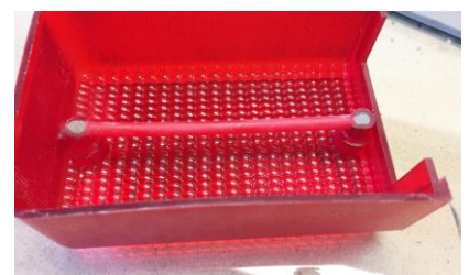
Fig. 4 schroefgaten zijn dicht gemaakt en ontluichtkanaal (rood) tussen 2 punten is aangebracht.
