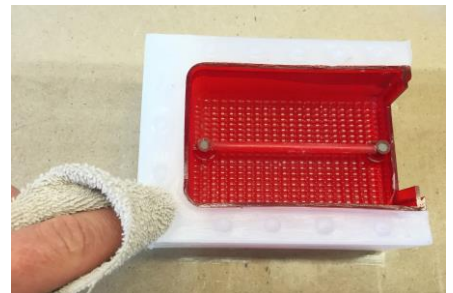
Fig. 11 De siliconen worden goed ingesmeerd met lossingspasta.
