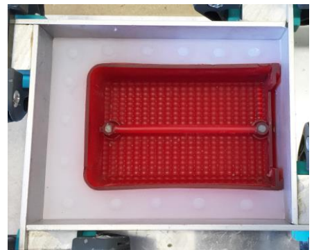
Fig. 12 De omkisting wordt weer rondom de siliconen aangebracht.
