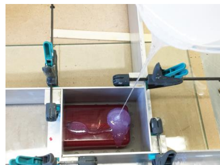
Fig. 8 Met een dunne straal wordt op één plaats gegoten.
