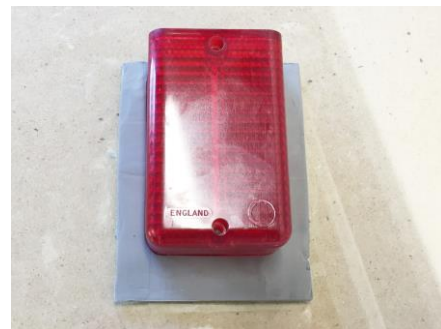
Fig. 5 De gietkant licht gelijk met de rand van de plasticine.
